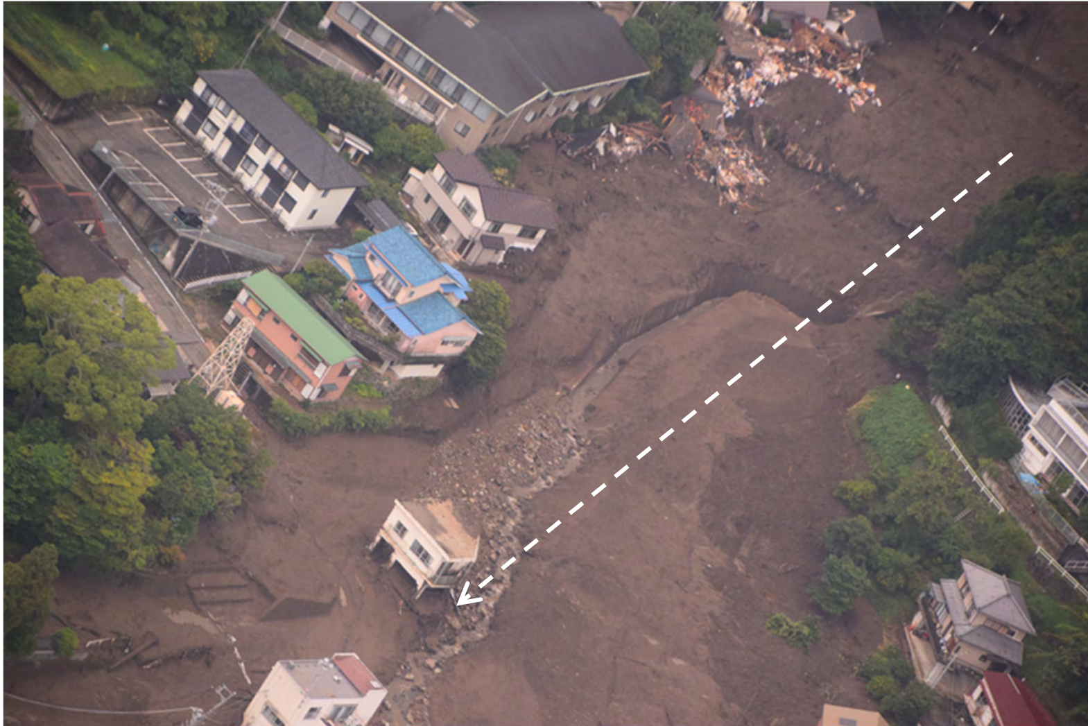
前写真の白枠内のズーム。流れの中心では家屋は流され宅地のひな壇状段差も浸食・堆積作用で消えかけている。(読売新聞社ヘリより筆者撮影)
