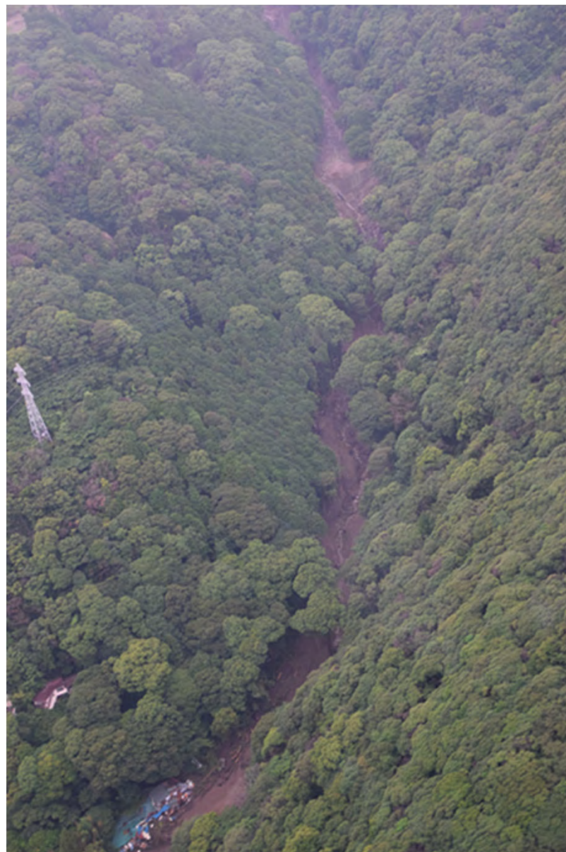
砂防ダム跡より下流は浸食幅が減少気味。 (読売新聞社へりより筆者撮影)
