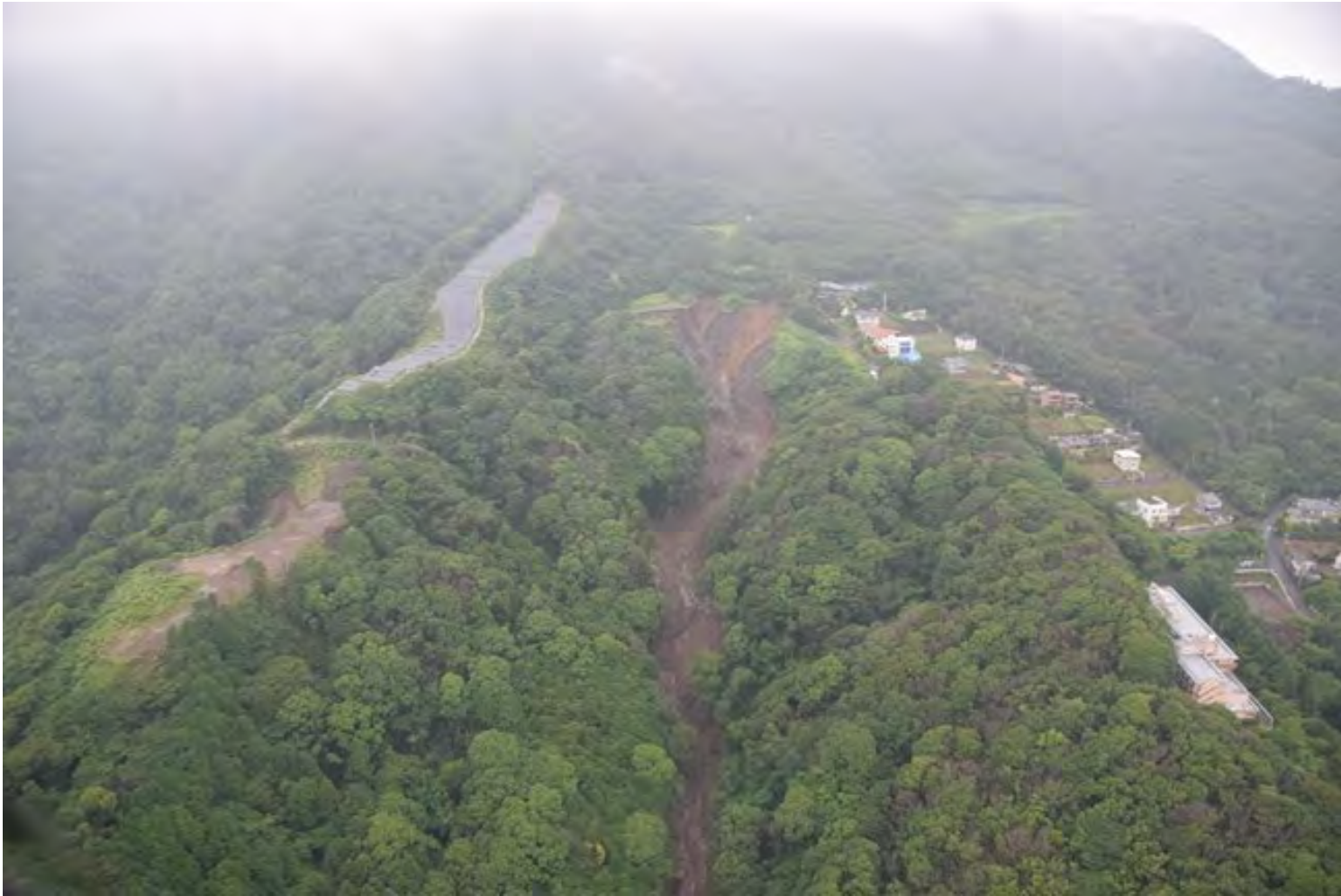
逢初川上流部の崩壊した源頭部を望む。(読売新聞社ヘリより筆者撮影) 崩壊盛土より上に谷地形はなく上流からの沢水供給は考えにくい。 (右側は開発された別荘地、左側は尾根部を整地して設置されたソーラーパネル)
