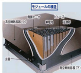
50kW×7.2時間の標準モジュール 電気ヒーター+真空断熱
