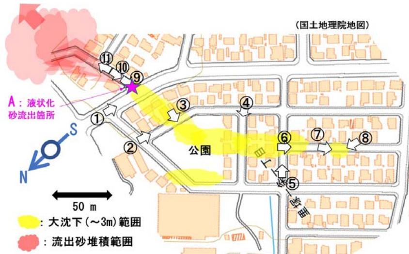
図-3 札幌市清田区里塚1丁目付近地図と液化化沈下影響範囲
