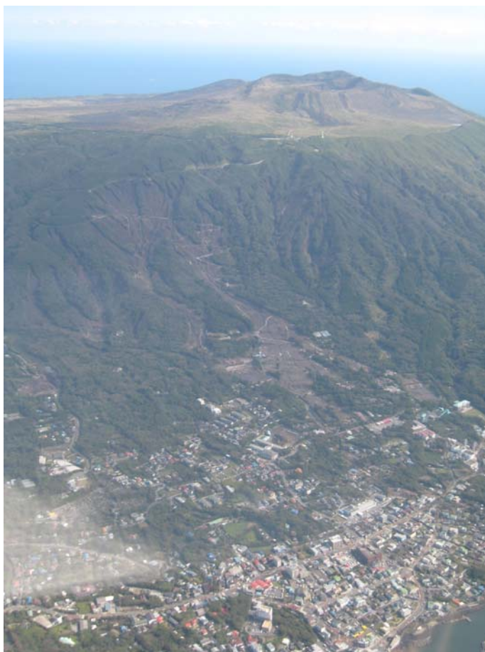
写真-1 三原山新山を囲む遷急線直下から発生した多数の崩壊。 ご神火スカイラインの道路沿いからスタートしたものが多く、 中央の2筋が元町の集落を襲った。
