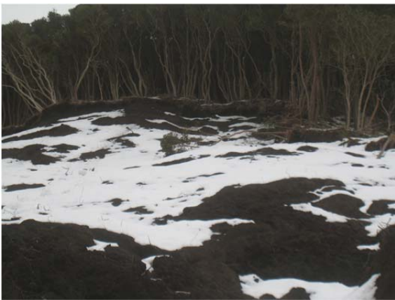
図-6 斜面上部地山際の滑り境界。 厚さ数10cm程度
