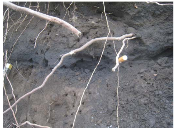
図-9 斜面中腹地山際の滑り境界地層断面。 ドライバーの柄の部分には粗砂の成層構造が見える。
