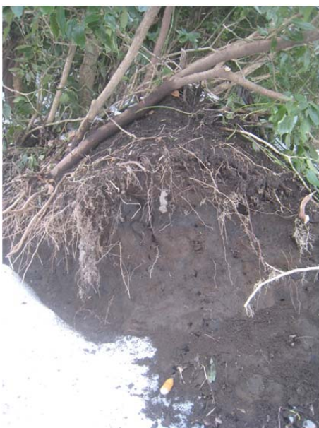
図-8 斜面上部地山際の滑り境界地層断面。 明確な層序は見えない。
