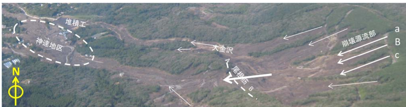
図-1 ヘリから見た崩壊斜面と泥流流下経路
