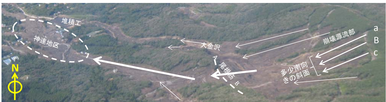
図-1 ヘリから見た崩壊斜面と神達への地区泥流流下経路
