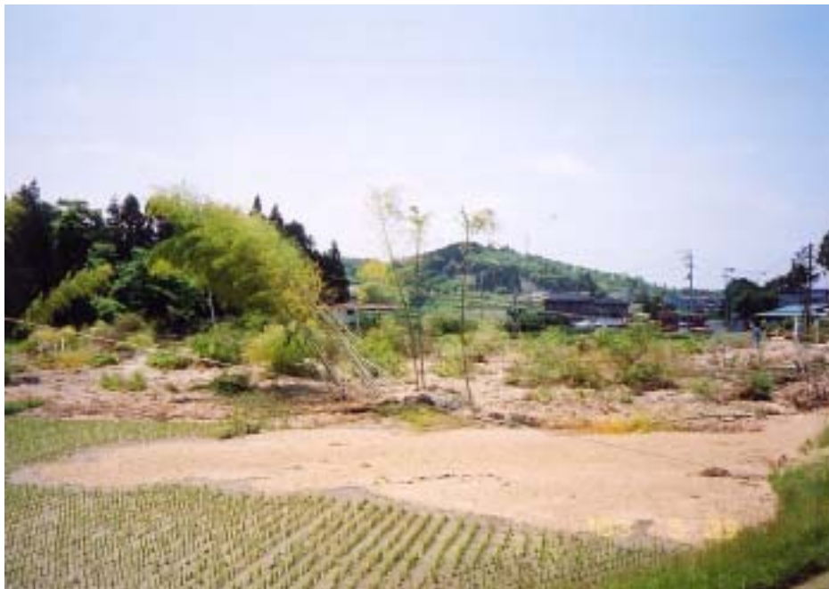
写真 - 4 流動堆積土塊左側で見られた液状化土と思われる細砂
