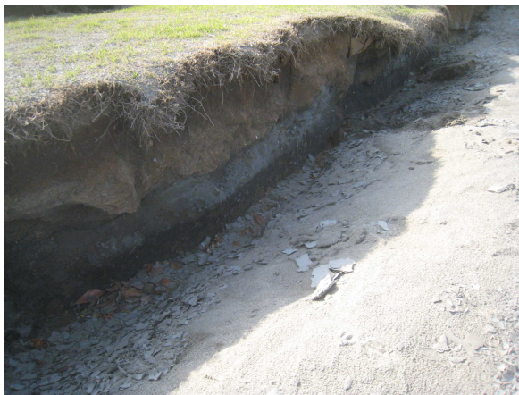
亀裂と深さ 3m ほどの陥没孔、30~50cm の表土の下は灰色の細砂が厚く堆積。
