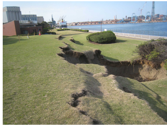
護岸に向かって 3 条ほどの開口・段差亀裂、右写真植込み横に陥没孔
