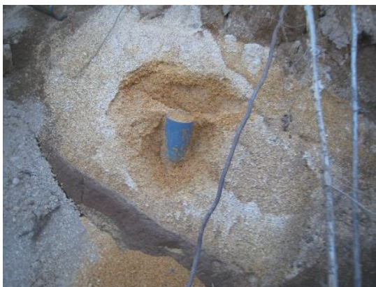
非粘性パミス挟み層と滑落崖の主体を占める暗褐色粘性層での試料採取
