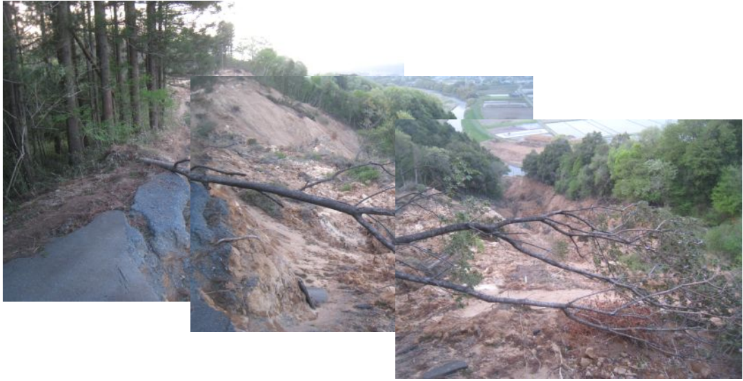
滑落崖の貼り合わせ写真。崩壊土の流路下流が漏斗状に絞られているのが分かる。
