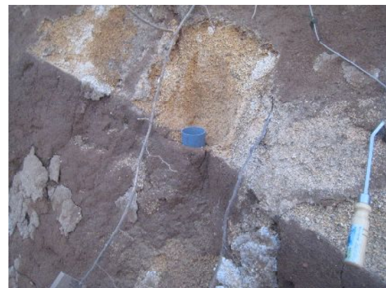
非粘性パミス挟み層と滑落崖の主体を占める暗褐色粘性層での試料採取
