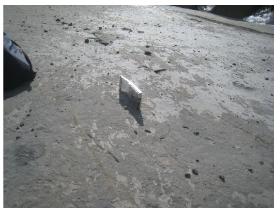
写真-9: 鏡肌砂岩層理面の傾斜は 21 度.
