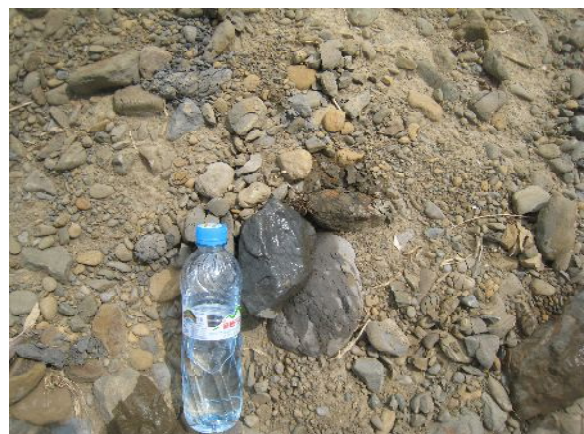
図-16 風化の進んだ泥岩と砂岩の比較。下の泥岩は水をかけると短時間で吸水する。
