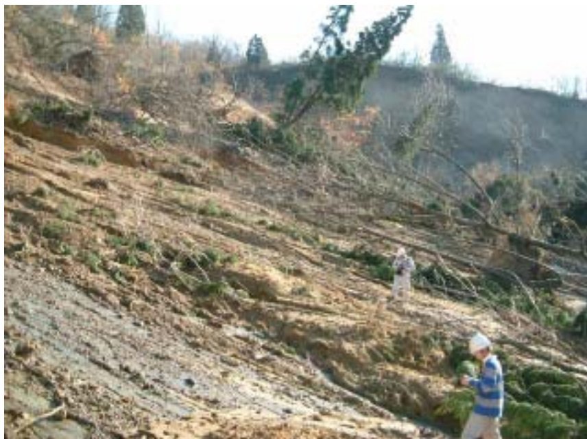
写真-24 地滑り斜面下部に現れた青灰色泥岩のまったく平滑な滑り面
