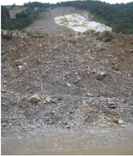
確認できた左岸側の層理面に沿った流れ盤滑り
